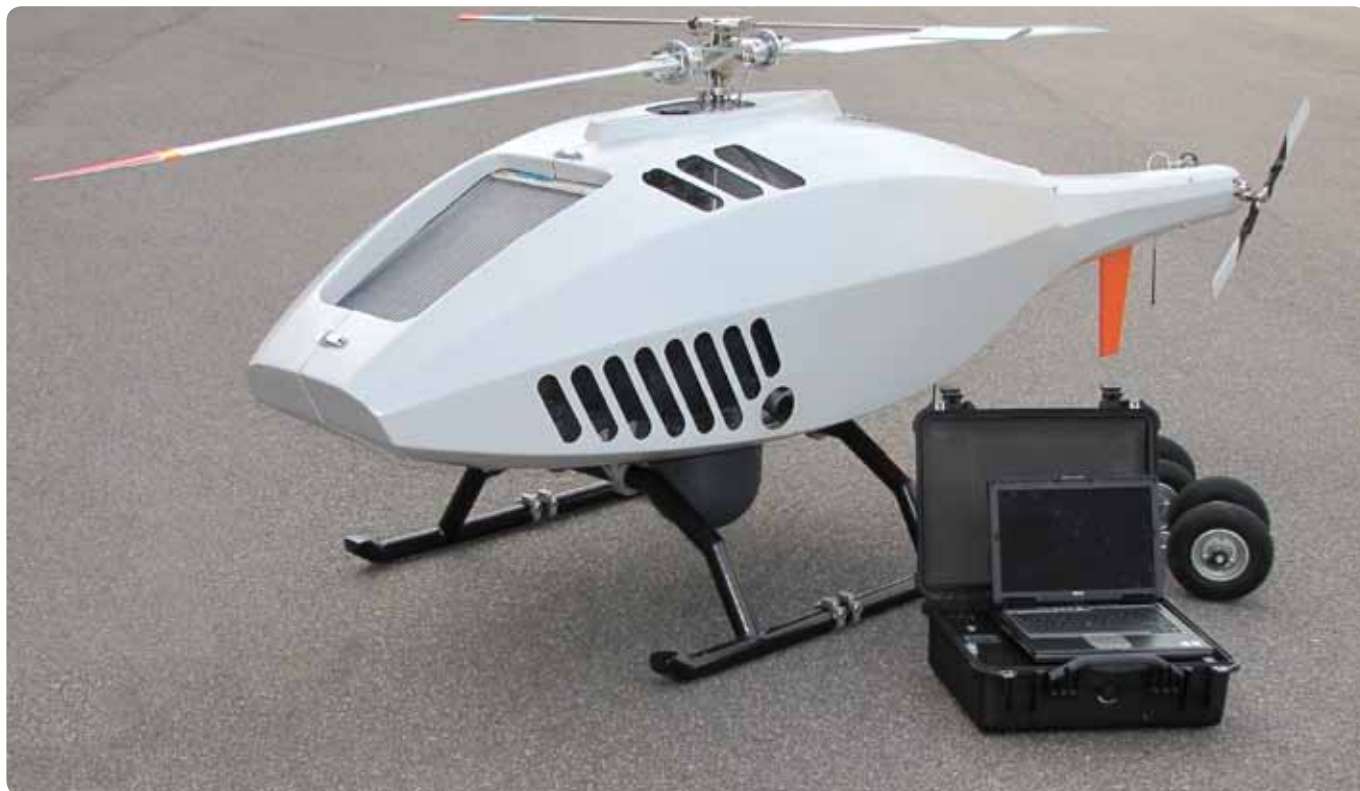
Systembild av de tre huvudkomponenter som ingår i ett system för obemannade helikoptrar. Bilden visar helikoptern, nyttolast i form av kamera (under helikoptern) samt en behändig markstation.
